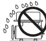
○プロワ運転音の気になる所（寝室・応接室等）より離して設置してください。
